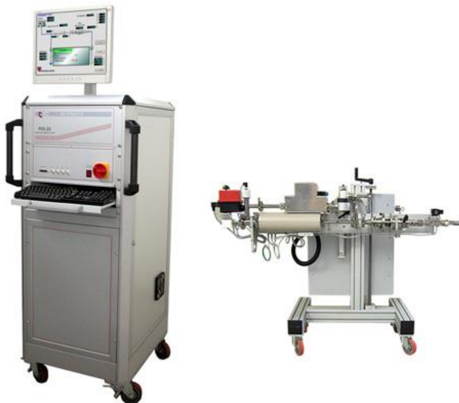
Abbildung 13-8: PSS-20 zur Entnahme von Rußproben
